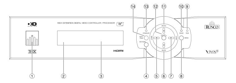
Figure 2-3. DHD Controller Front Panel
